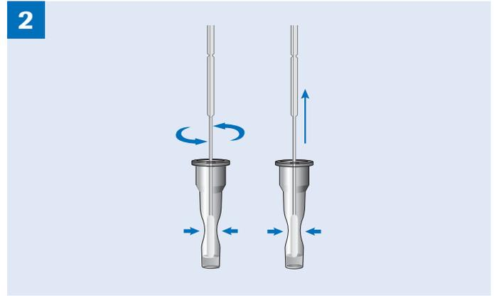
Die Probe wird durch Rotationsdrehung im Extraktionspuffer gelöst. Anschließend kann das Teststäbchen wieder entnommen werden.
