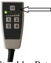
Durch erneutes Betätigen der I/O-Taste wird der Unterdruck abgeschaltet. Anschließend wird automatisch ausgeblasen.
