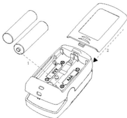
Abb. 3 Batterieinstallation
