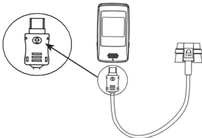
**Abb. 4 Externe SpO<sub>2</sub>-Sensor Verbindung (insbesondere PC-60E + 60NW)**
